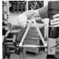
5 用手摇柄给进单元，使第一次穿过镗孔有足够的行程。拧紧旋转驱动环，并将旋转驱动装置固定在杆上
