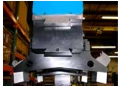
5. 将驱动电机连接到 RDU，将轴向进给连接到镗杆。
