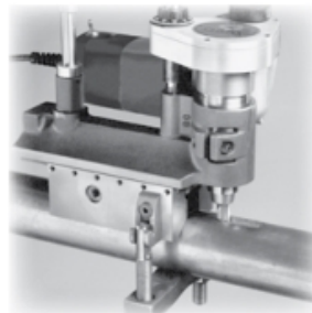
安装在中部，机器可以调屏，可以切割长键槽
